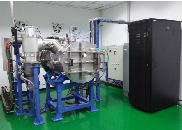
รูปที่ 2 เตาเบรซิงจากสถานที่จริง ณ สถาบันวิจัยแสงซินโครตรอน จ.นครราชสีมา
