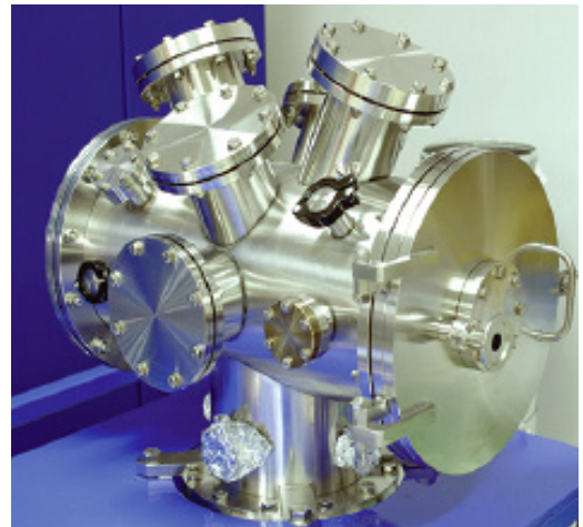
รูปที่ 3 ตัวอย่างชิ้นส่วนอุปกรณ์สุญญากาศที่ผลิตขึ้นและถูกนำไปติดตั้งใช้งานภายในสถาบันวิจัยแสงซินโครตรอน
