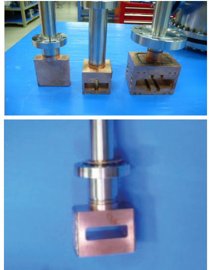
รูปที่ 4 ตัวอย่างชิ้นงานที่พัฒนาขึ้นโดยการ เชื่อมต่อโลหะด้วยวิธีเบรซิ่ง สำหรับใช้ใน ระบบสุญญากาศและเครื่องเร่งอนุภาคภายใน สถาบัน
