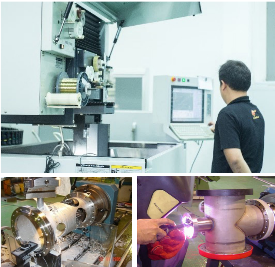
รูปที่ 2 การผลิตชิ้นส่วนสุญญากาศระดับสูงยิ่งยวด (UHV) ประสิทธิภาพสูง โดยสถาบันวิจัยแสงซินโครตรอน ที่มีคุณภาพเทียบเท่ากับของที่ผลิตจากต่างประเทศ
